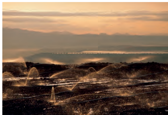
La première étape du procédé SX/EW : une zone de lessivage dans une mine de cuivre en Arizona aux USA.
