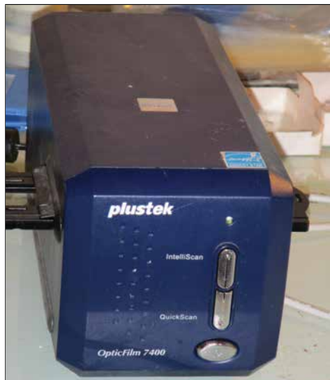
Photo 23: Matériel permettant de déterminer la race d'une abeille à partir de son aile: lecteur d'images.
